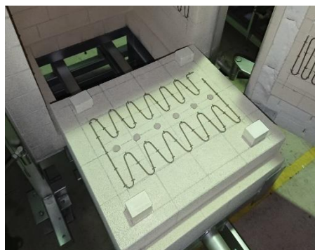
四隅におかれたサイコロ支柱
