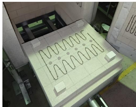
四隅におかれたサイコロ支柱
