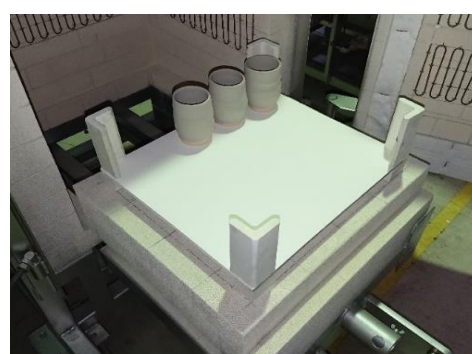
L型支柱を棚板の四隅に立てる
